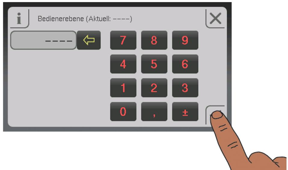
Nach der Eingabe des Bediener-Codes wird das Grundbild mit der aktuellen Bediener-ebene oberhalb des Favoriten-Symbols angezeigt.
