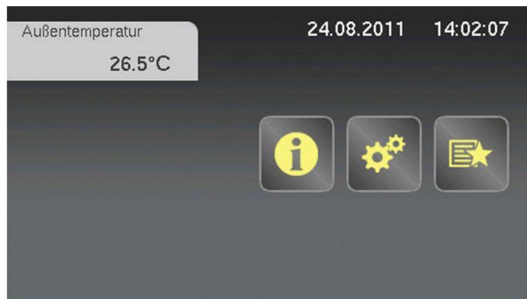
Im Grundbild wird lediglich die Außentemperatur angezeigt, da dem RBG 3200 Touch noch keine Komponenten zugewiesen sind.
